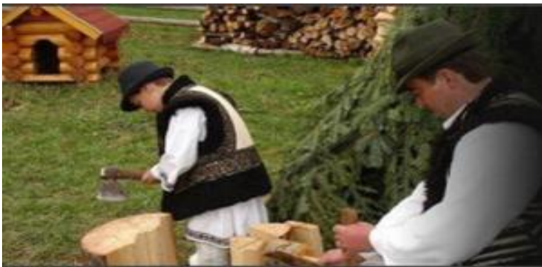
Imaginea 4.6: Procesul de fabricare al șindrilei
